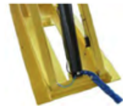
CE-Stopheinrichtung für endgültiges Senken mit akustischem Signal
