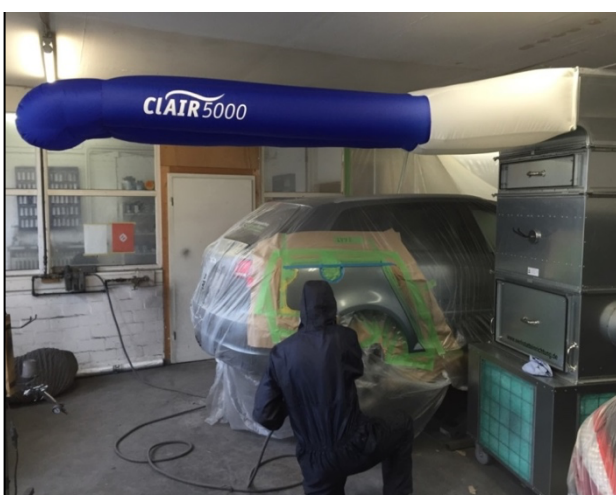
für niedrige Räume mit kurzem Filterkanal (Mindestraumhöhe 2,65 m) Gerät nur 2,43 m anstatt 2,65 m hoch
