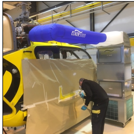
Spot Repair am Hubschrauber
