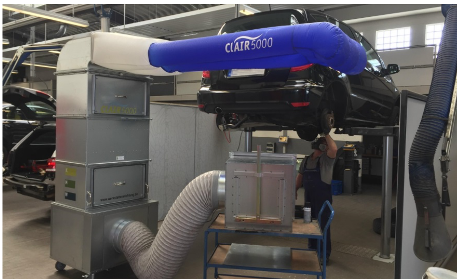
mit Trichter auf Fahrwagen platziert, z.B. zum Spritzen von Unterbodenschutz
