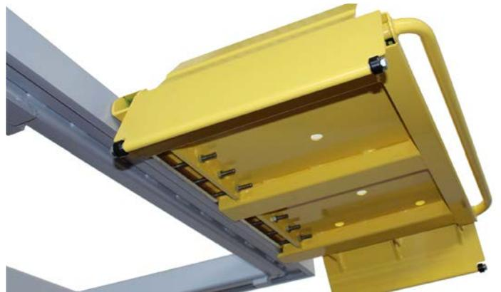
Gleitlager für ein einfaches verschieben der Aufnahmeplatten Die Neigung / Ausrichtung der Aufnahmeplatten kann angepasst werden
