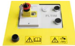
Notausknopf mit Schlüssel gegen unbefugte Benutzung
