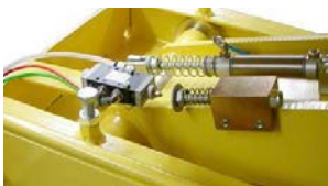
Stoppeinrichtung für endgültiges Senken mit akustischem Signal (an JO.30 JP und JO.35)
